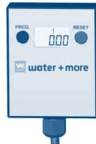
Os dados até aí memorizados não se perdem durante a substituição da pilha.
